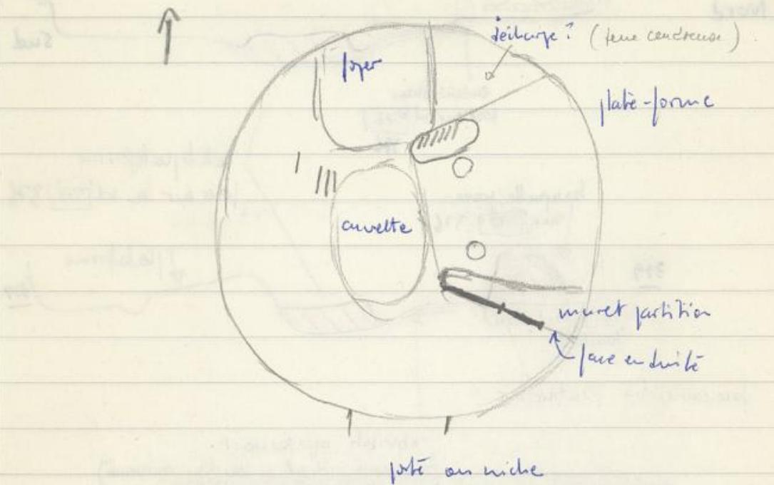
ouverture maintenable large de 0,55m = le mur s'arrête sur 2 lignes vertes et le sol remonte au pour un seuil
